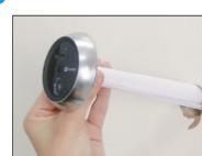
Führen Sie die Schrauben und Kabel durch die Tür. Als Führungshilfe können Sie das Trennpapier aufrollen.
