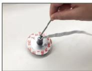
Drehen Sie die Schraube in die Rückseite der Kamera ein.
