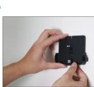
Führen Sie die Schrauben durch die Befestigungslöcher.
