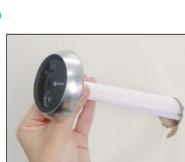
Führen Sie die Schrauben und Kabel durch die Tür. Als Führungshilfe können Sie das Trennpapier aufrollen.
